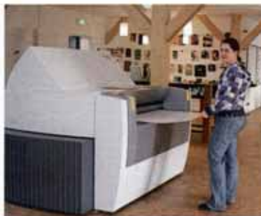
Umweltfreundlich: Die CTP-Produktion erfolgt auf einem Heidelberg SupraSetter mit prozesslosen Thermal-Direct-Platten von Kodak.
