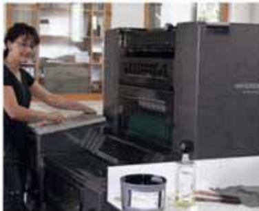
Alkoholfrei: Stefanie Lang an der Heidelberg Speedmaster 52, die auch ohne Alkoholfuchtung beste Qualität bietet.
